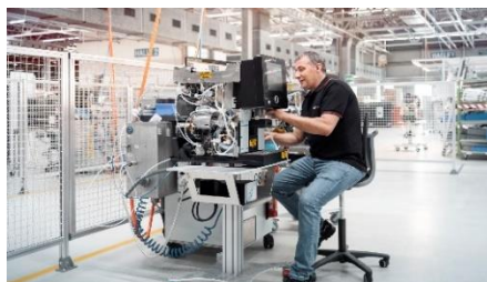
Chaque machine à café Schaererer est mise en service et testée à Zuchwil.
